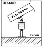
Kapama plakası ayarlanabilir. Montajdan önce konumunu kontrol edin.
