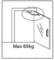
Kapı kapatıcısının tutma kuvveti elektromanyetik kapı tutucusunun tutma kuvvetinden daha düşük olmalıdır.
