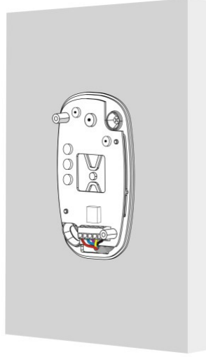
Şekil 7.2 ES Kablo Bağlantılarının Yapılması
