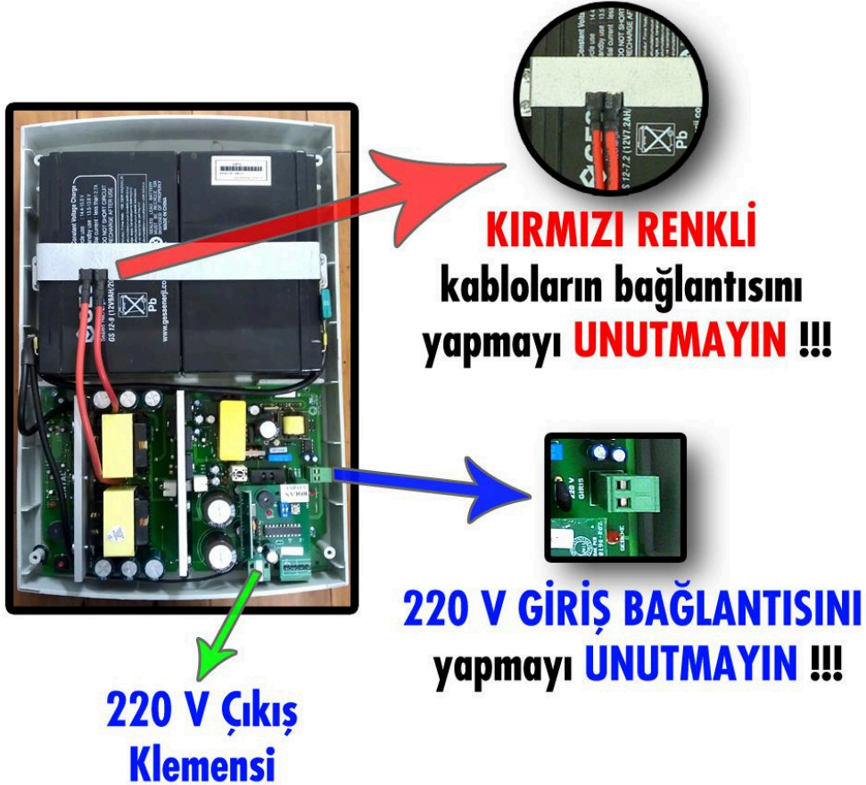
Şekil 2 - VForce Bağlantı Şeması
