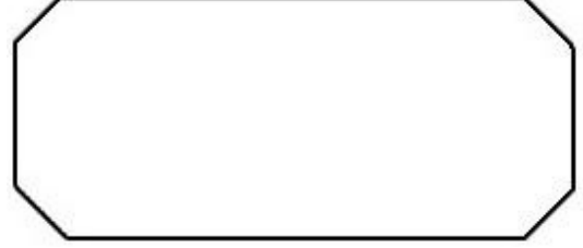
Köşeleri 450 kesilmiş loop alanı ( TAVSİYEEDİLİR )
