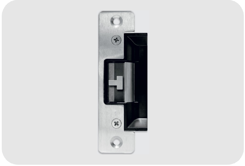
OMEGA ANSI TİP ELEKTRİKLİ KİLİT KARŞILIĞI İZLEME KONTAKLI Omega Ansi Tip, Fail Secure - NC / Fail Safe - NO Elektrik Yokken Kilitli / Elektrik Varken Kilitli, İzleme Kontaklı
